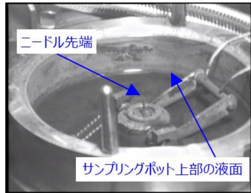
サンプルポット蓋内部の状況
